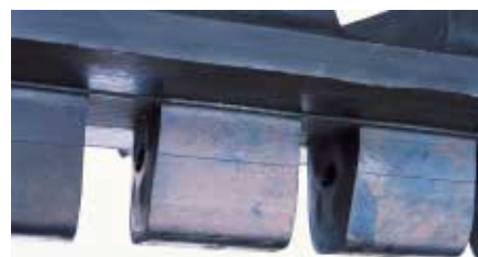
Elementy prowadzące centrują pas na kołach napędzających i kołach napinających.
