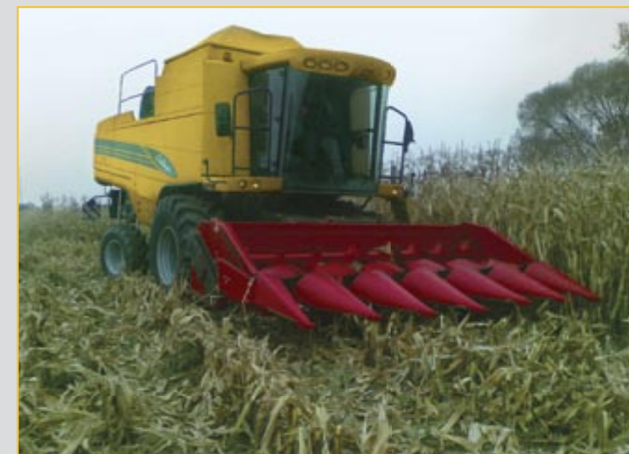
Challenger 648'eren udstyret med 6-rækket majsbord hos RSP Dorozki. Det gennemsnitlige brændstofforbrug for maskinen i den våde høst i 2008 blev registreret til 15 l/ha.
