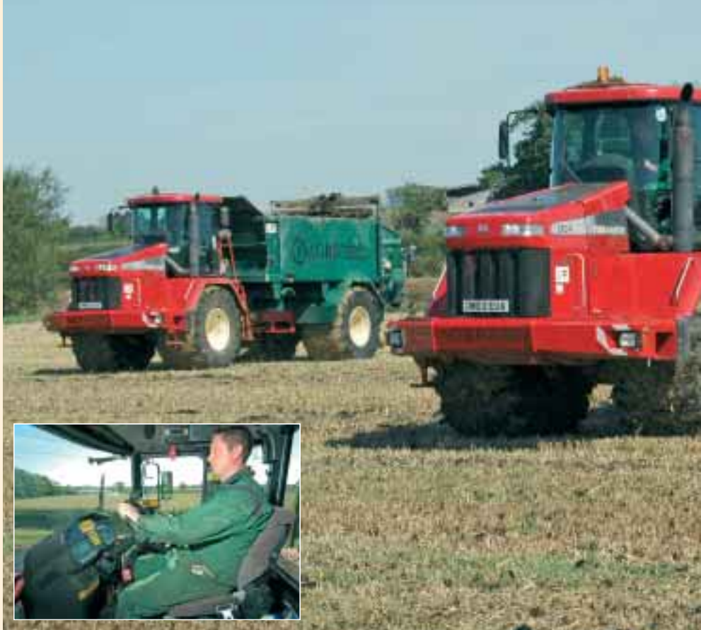
▲ Agrivert provozuje vysoce kapacitní zařízení pro rozmetání tuhých biologických kalů, v celkovém ročním množství 750 000 tun. Strojový park zahrnuje 12 Ag-Chem Terra Gatorů a průměrné dávkování je od 20 do 40 tun/ha.
