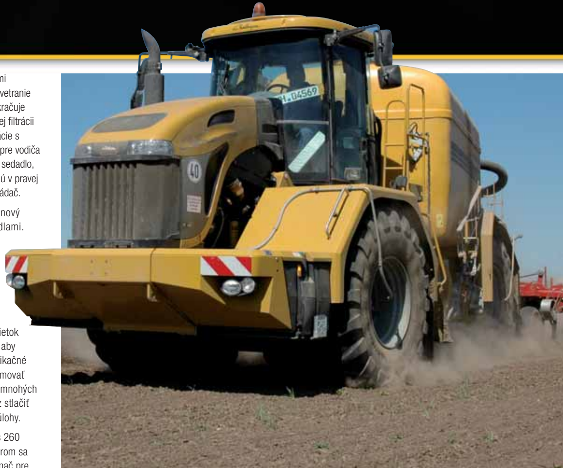
▲ Pneumatiky Michelin 1050/50R32 sú najväčšie dostupné pneumatiky a zabezpečujú maximálnu ochranu pôdy.
