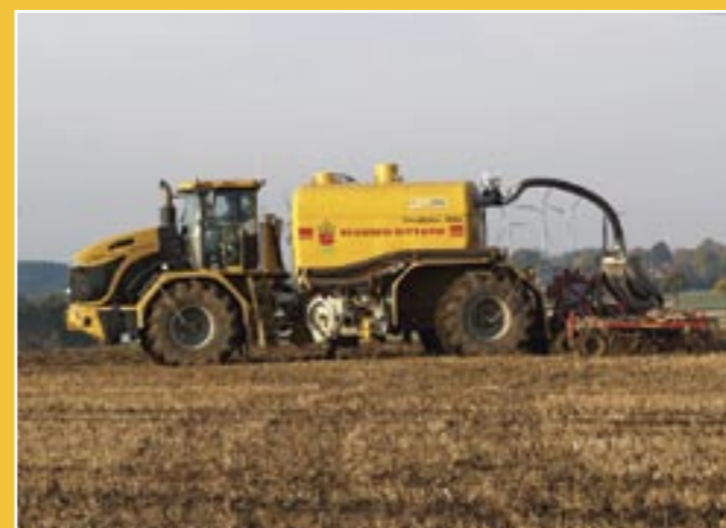
Spotreba paliva aplikátora TG 3244 je len 21 – 25 litrov nafty/h.
