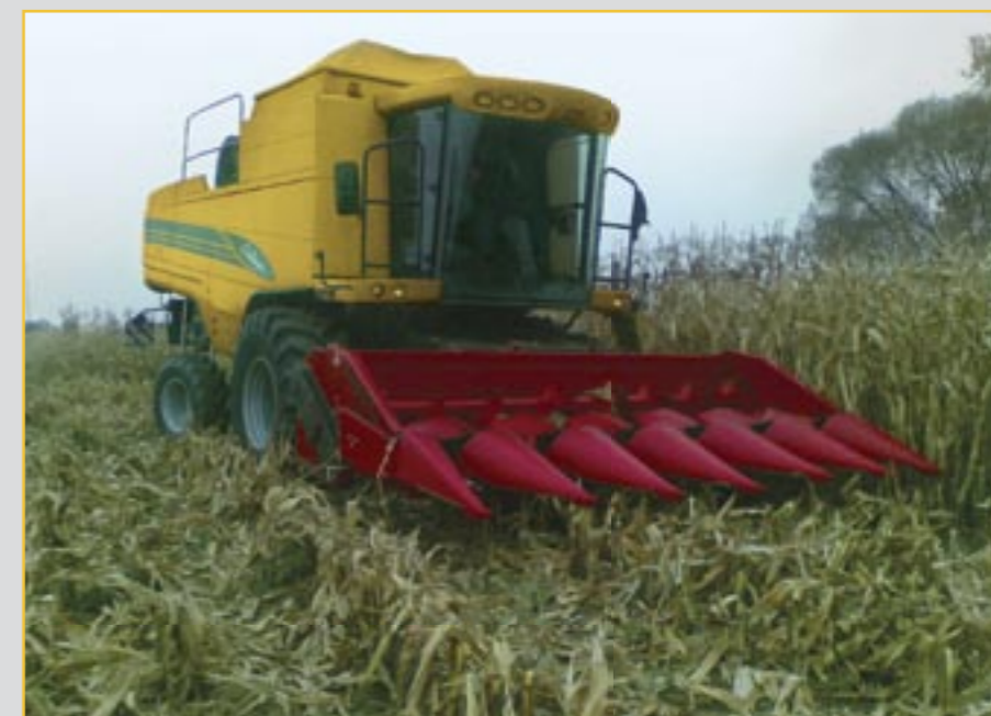
Kombajn Challenger 648 vybavený 6-riadkovou hlavou na zber kukurice v družstve RSP Dorozki. V mokrej žatve v roku 2008 sa pre stroj zaznamenala priemerná spotreba paliva 15 l/ha.
