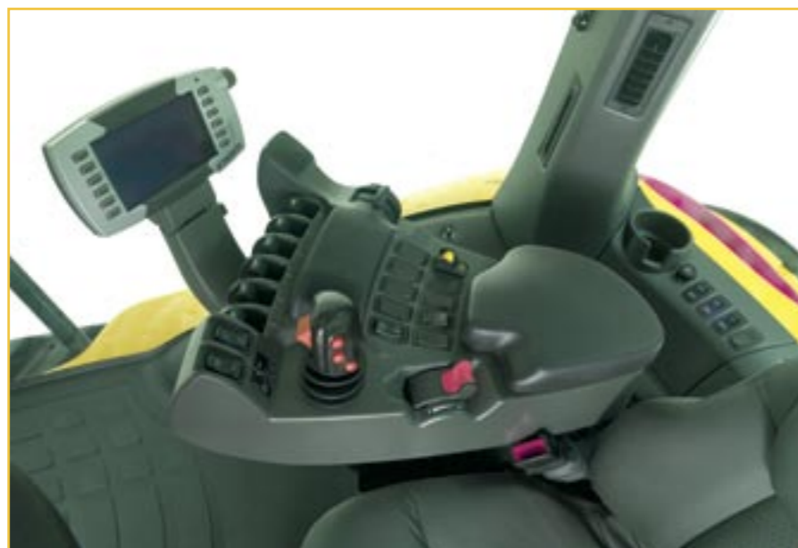
Nový kabínový terminál v traktoroch Challenger série „C“ funguje ako nervové centrum stroja.
