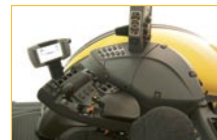
Ergonomicky navrhnutá opierka ruky TMC sústreďuje všetky dôležité ovládacie prvky hneď vedľa sedadla.
