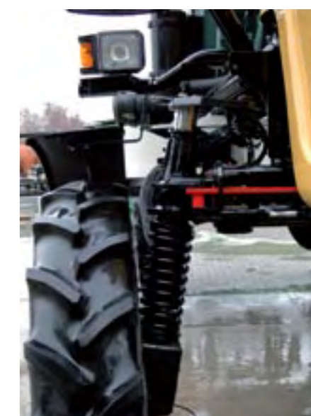
▲ Pružiny s premenlivou tuhosťou boli nahradené lineárnymi pružinami, ktoré poskytujú väčšiu voľnosť pohybu odpruženia.
