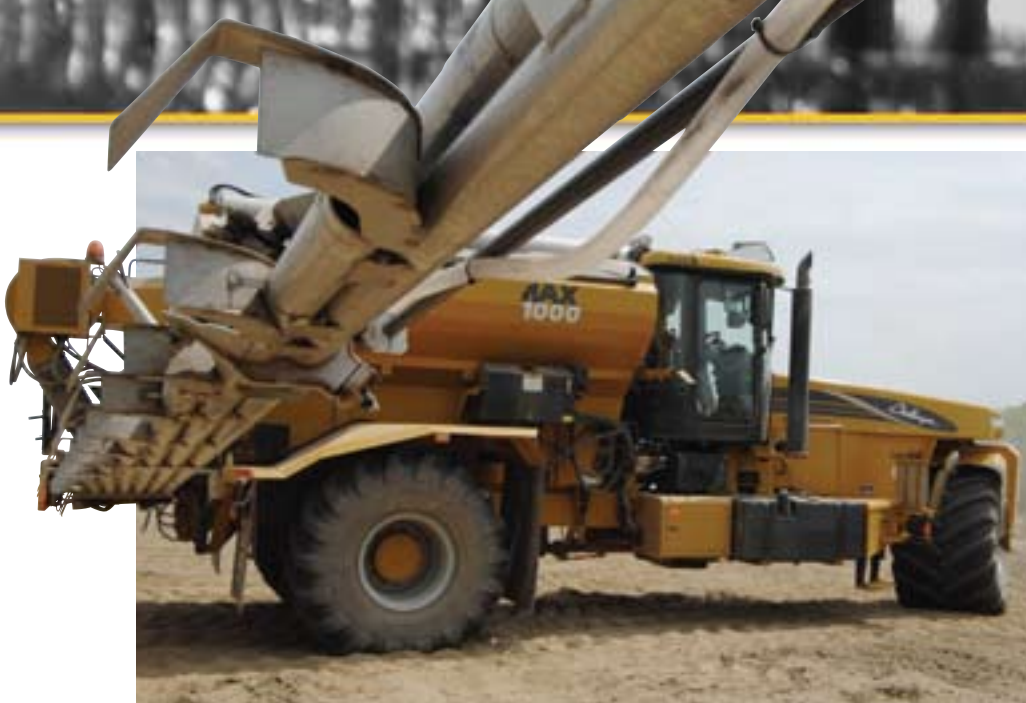
▲ Aplikátor Terra Gator 8203 s pneumatickým rozprašovačom umelých hnojív Air Max.
