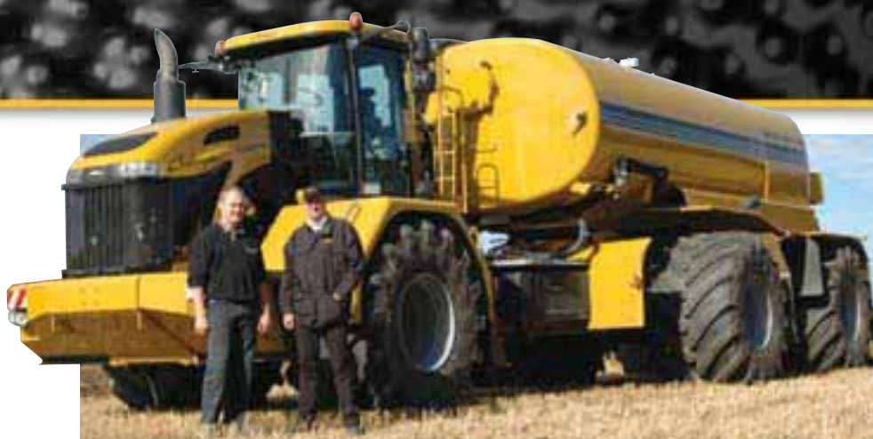
◀ Nový kejdovač Terra Gator 3244 s návěsem NMS dokáže pojmout náklad až 27,5 m 3 . Vlevo: Ulrik Jacobsen. Vpravo: Torben Galsgaard od Challengeru.
