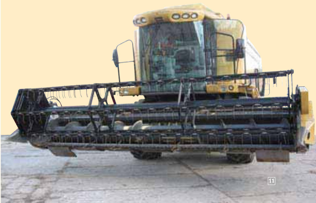
▲ Konstrukce poháněného pásu lišty PowerFlow zaručuje rovnoměrné dodání plodiny do šnekového dopravníku klasem napřed.
