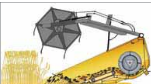
▲ Konstrukce poháněného pásu lišty PowerFlow zaručuje rovnoměrné dodání plodiny do šnekového dopravníku klasem napřed.
