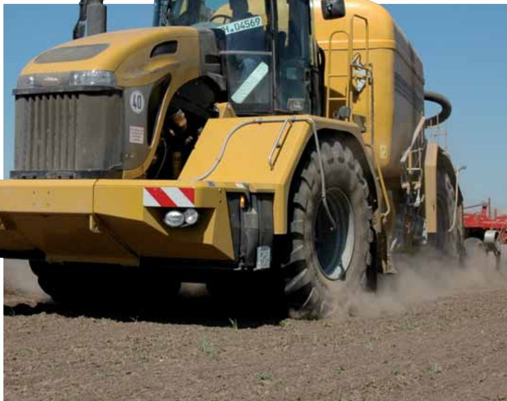
▲ Pneumatiky Michelin 1050/50 R32 jsou největší dostupné pneumatiky a zajišťují maximální ochranu půdy.
