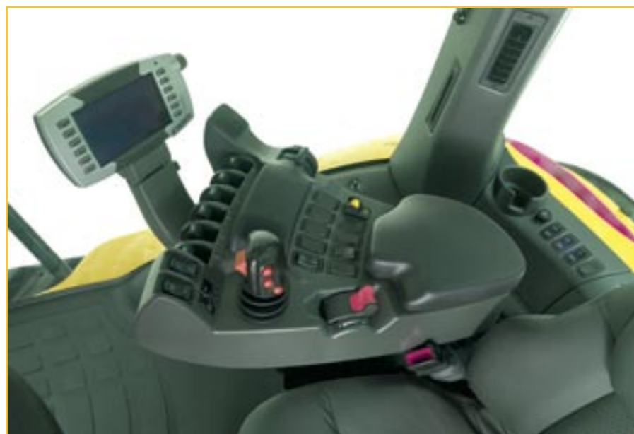
Nový kabinový terminál strojů řady Challenger „C“ slouží jako mozek stroje.
