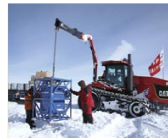
Modely MT865B zakoupené organizací Polar Research Institute of China pracují v teplotách až -50 °C.
