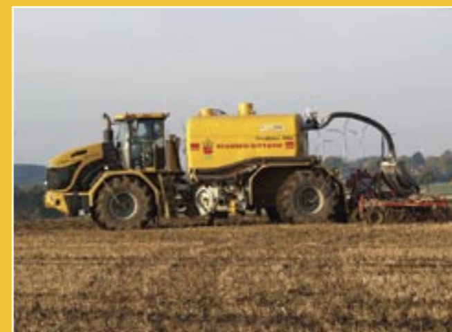
Spotřeba paliva u stroje TG 3244 je pouhých 21–25 litrů naftu za hodinu.
