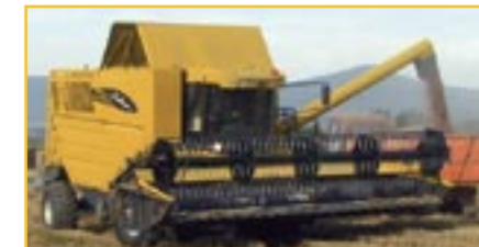
V Maďarsku dosahoval stroj Challenger 654 za velmi nepříznivých podmínek v pšenici průměrného výkonu 3,66 ha/h.
