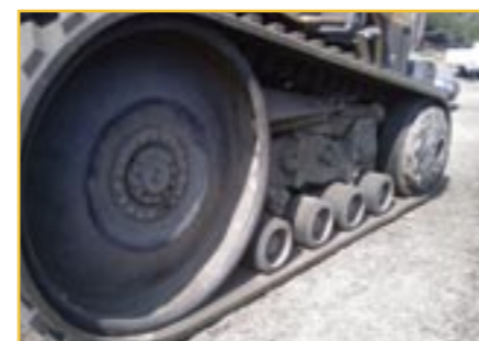
Po 650 hodinách nevykazuje systém pásů žádné známky nadměrného opotřebení.
