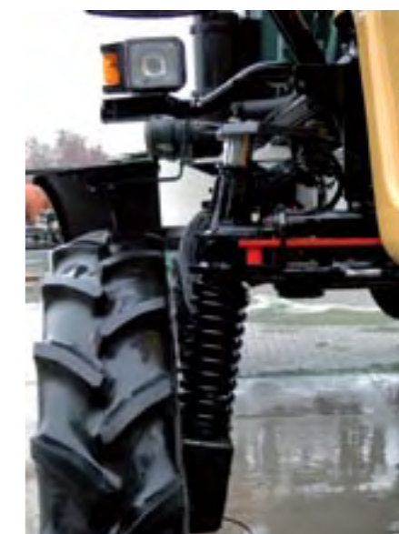
▲ Pružiny s proměnnou charakteristikou byly nahrazeny lineárními pružinami pro zajištění většího pohybu pérování.
