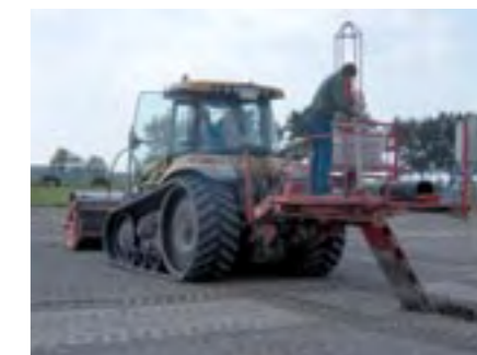
▲ Klaas Fekkes se specializuje na melioraci, drenážní práce a srovnávání půdy. Jakmile drenážní stroj odvedl svoji práci (na obrázku za traktorem) a potrubí je položeno, traktor Challenger couvá ve stejném směru s válcem připojeným k dvoufunkčnímu přednímu závěsu, pěchuje půdu a eliminuje koleje.
